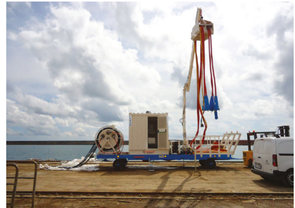
Fig.17B Struttura mobile per l'alimentazione delle navi
