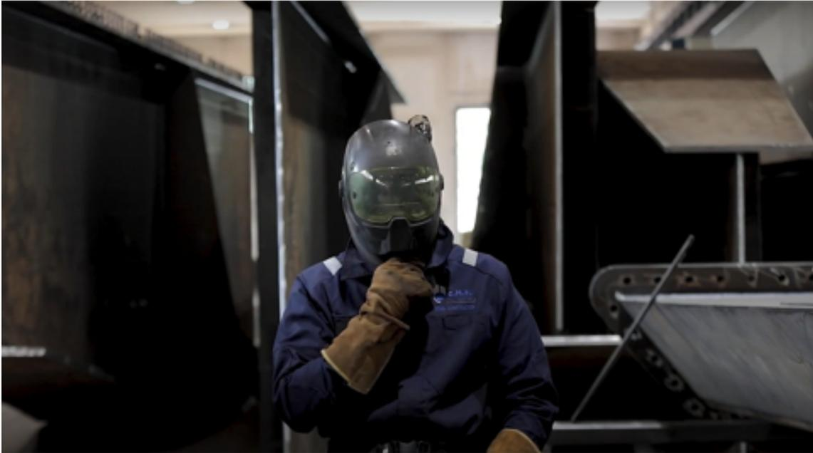
**La realizzazione dei due ponti metallici, a opera dell'impresa specializzata C.M.M F.LLI RIZZI S.r.l., avviene mediante la sagomatura di lamiere piane tramite complesse procedure di assemblaggio e saldatura all'interno della sede operativa di Vezza d'Oglio, in provincia di Brescia, per poi essere trasportati e successivamente assemblati nelle aree di cantiere a partire da fine luglio.**
